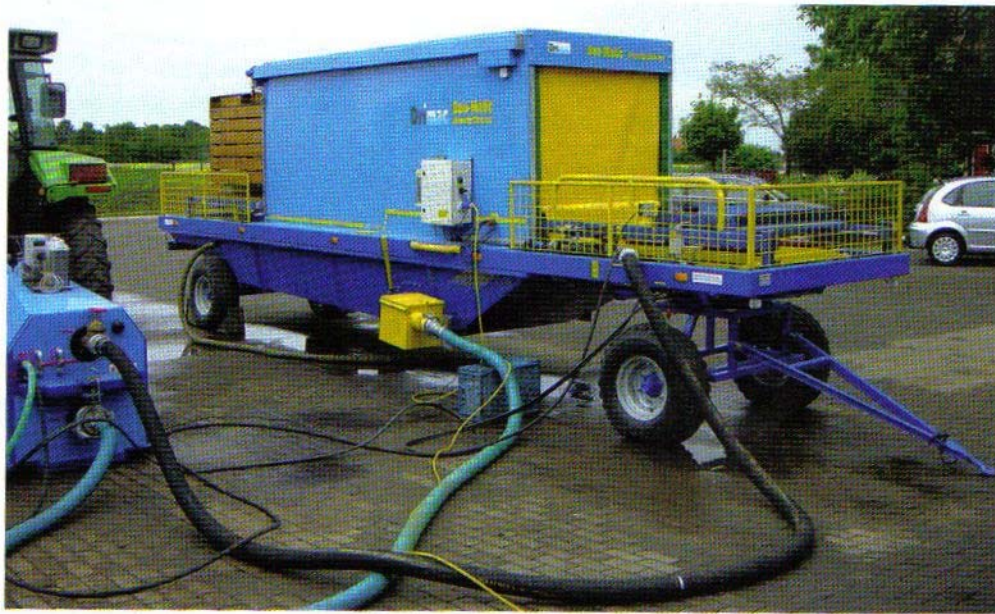
Met een automatische palletkistenreiniger die kan ontsmetten, krijg je de schoonste kisten zonder bacteriën en schimmels.
